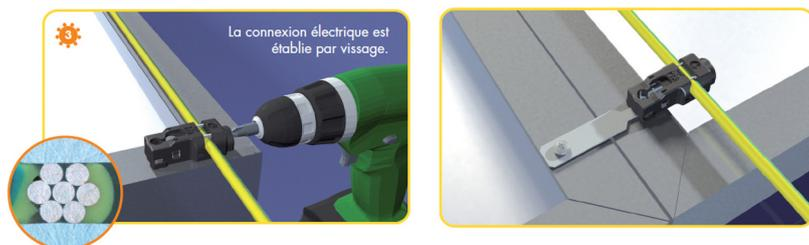
La connexion électrique est établie par vissage.
